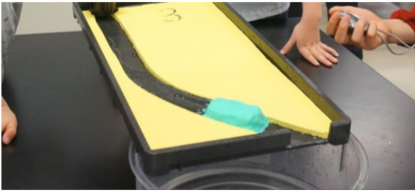
【図 11：水路を封鎖し、水が溢れる場所を調べる】
